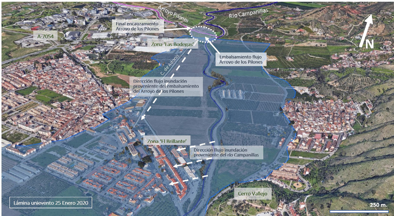
Figura 5. Recreación de la lámina unievento con direcciones de flujos de inundación
