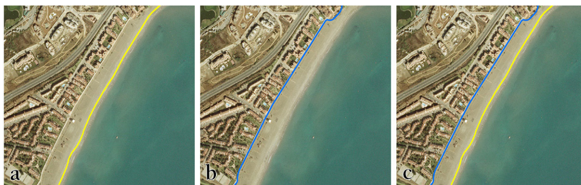
Figura 3. Criterios para la digitalización de la playa: a) Marca húmeda de la última marea alta, b) Límite interno de la playa seca, c) Superficie entre el límite interior y exterior de la playa seca.
